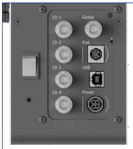
Figura 16: Pannello posteriore di pE-400 max che mostra l'interruttore di accensione/spegnimento (a sinistra), la presa pod e le prese di alimentazione con i segni circostanti per orientare i connettori (a destra).
