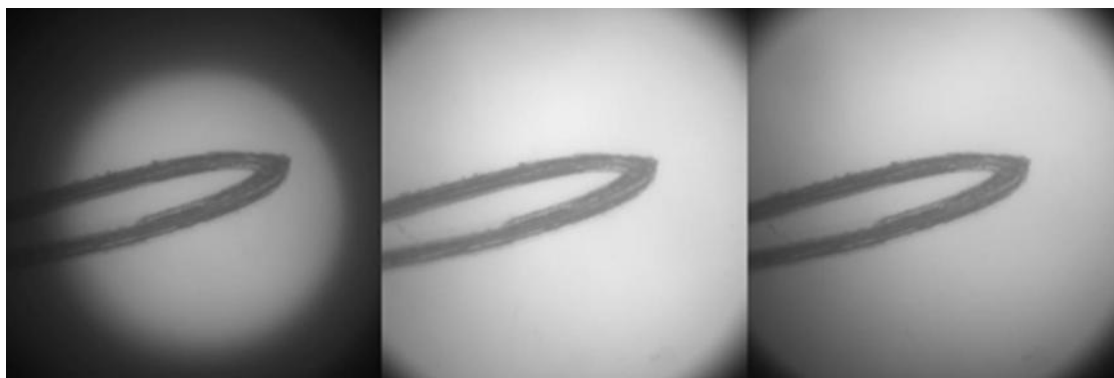
Figura 30: (Da sinistra a destra) Un piano di campionamento insufficiente (è necessario regolare la messa a fuoco), un punto luminoso centrale (è necessario regolare la messa a fuoco), il più omogeneo (messa a fuoco ottimale).
