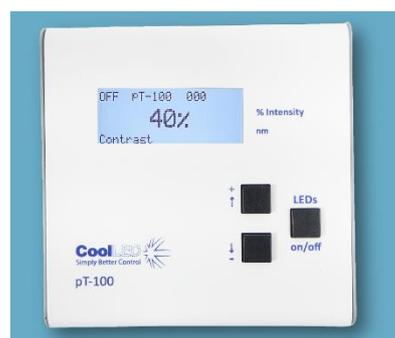
O próximo ecrã apresentado é o do ajuste **do contraste**. O contraste pode ser ajustado utilizando os dois botões de seta. Este é ajustado em incrementos de 1 %.
