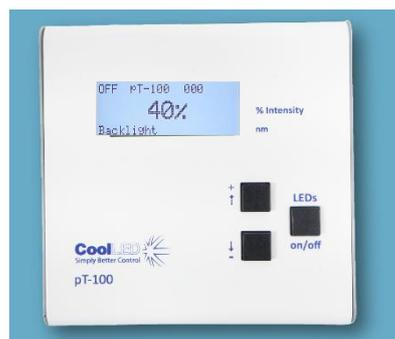
A primeira opção apresentada é o ajuste **da luz de fundo**. A definição pode ser ajustada utilizando os dois botões de seta. Este ajuste é efectuado em incrementos de 1 %.
