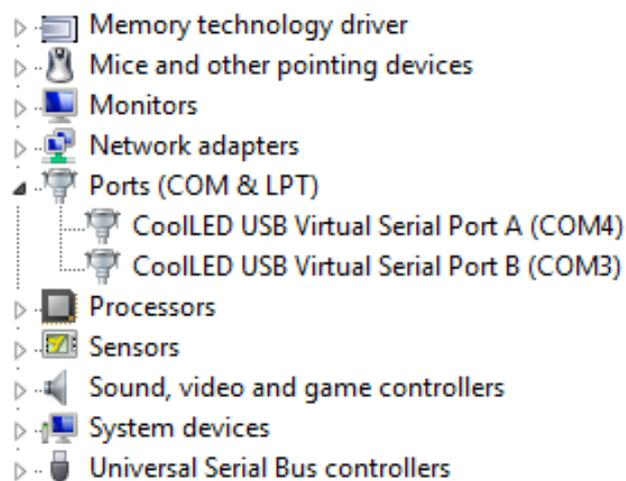
在本例中，照明系统被分配了两个 COM 端口：COM3 和 COM4。您可能需要这些信息才能通过软件控制包连接光源。任何一个 COM 端口都可用于控制。分配两个 COM 端口是为了在通信的同时进行诊断，并在需要时实现双通信。
