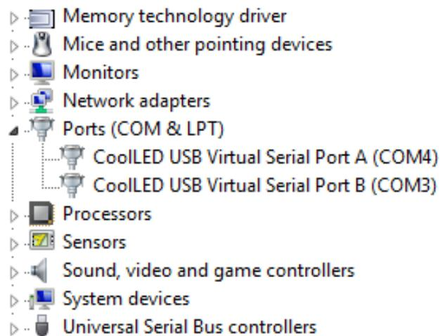
Dans cet exemple, deux ports COM, COM3 et COM4, ont été attribués au système d'éclairage. Vous pouvez avoir besoin de ces informations pour vous connecter à la source lumineuse à partir de votre logiciel de commande. L'un ou l'autre des ports COM peut être utilisé pour la commande. Deux ports COM ont été attribués pour permettre d'effectuer des diagnostics parallèlement à la communication et également pour permettre une double communication si cela s'avérait nécessaire.
