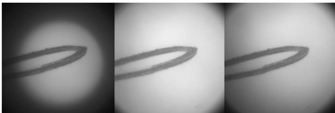
图 30：（从左到右）样本平面填充不足（需要调整焦距）、中心亮点（需要调整焦距）、最均匀（最佳焦距）。
