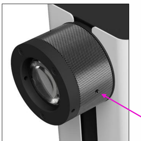
Figura 29 : Fonte de luz de encaixe direto da série pE-400 ajuste ótico obtido rodando o cilindro de saída de luz. Os parafusos de fixação (seta ciano) devem ser desapertados primeiro.
