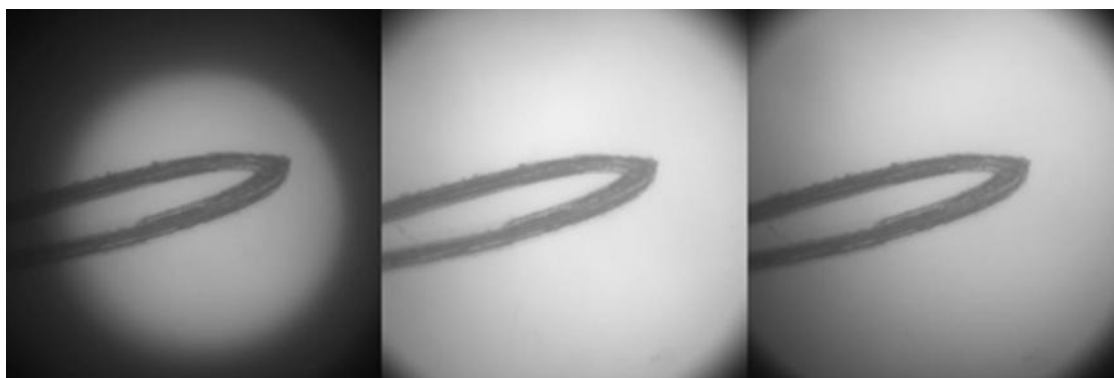
Figura 30: (Da esquerda para a direita) Um plano de amostra subpreenchido (são necessários ajustes de focagem), um ponto brilhante central (são necessários ajustes de focagem), mais homogêneo (focagem ideal).
