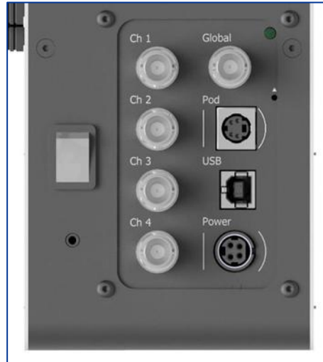
Figura 16: Pannel posterior do pE-400 max mostrando o interruptor On/Off (à esquerda), a tomada do pod e as tomadas de alimentação com marcas circundantes para orientar os conectores (à direita).
