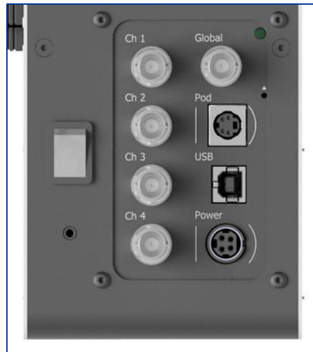
그림 16: 온/오프 스위치(왼쪽)와 커넥터 방향을 안내하는 주변 표시가 있는 포트 소켓 및 전원 소켓(오른쪽)이 표시된 pE-400 최대 후면 패널.
