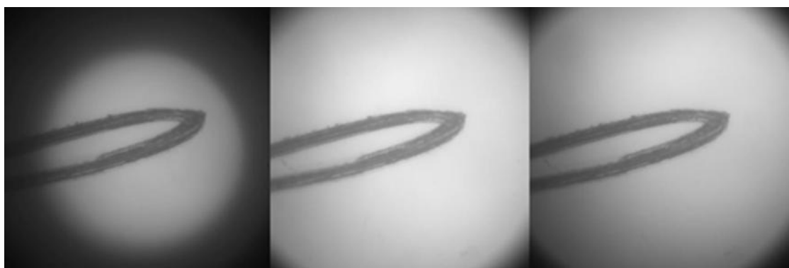
図30: (左から右へ)不十分な試料面(焦点調整が必要)、中央の輝点(焦点調整が必要)、最も均質(最適焦点)。
