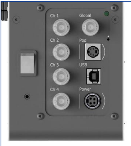
Figure 15: Panneau arrière du pE-400 max montrant l'interrupteur marche/arrêt (à gauche), la prise pod et les prises d'alimentation avec les marques environnantes pour guider l'orientation des connecteurs (à droite).
