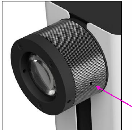
Abbildung 29 : Eine Direktmontage-Lichtquelle der Serie pE-400. Die optische Einstellung erfolgt durch Verdrehen des Lichtaustrittszyinders. Die Madenschrauben (cyanfarbener Pfeil) müssen zuerst gelöst werden.
