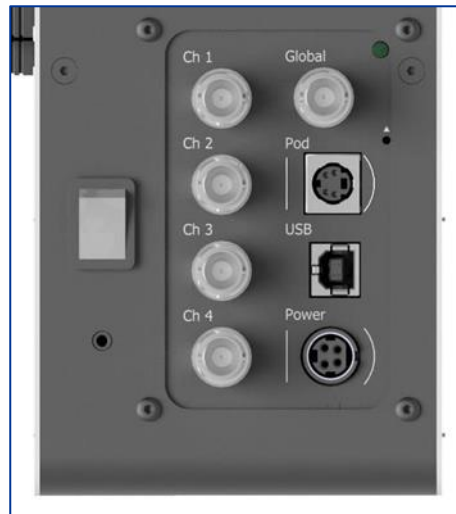
Figura 16: Panel trasero de la pE-400 max que muestra el interruptor de encendido/apagado (izquierda) y el zócalo del módulo y los zócalos de alimentación con marcas alrededor para guiar la orientación de los conectores (derecha).
