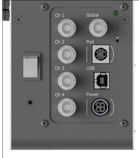
그림 16 - pE-400 max 켜기/끄기 스위치가 표시된 광원 백 패널(왼쪽), 커넥터 방향을 안내하는 주변 표시가 있는 포트 소켓 및 전원 소켓(오른쪽).
