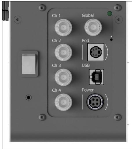
図16-- pE-400<sup>max</sup> 光源背面パネル。オン/オフスイッチ (左)、ポッドソケットと電源ソケット、コネクタの方向を示す周囲のマーク (右)。
