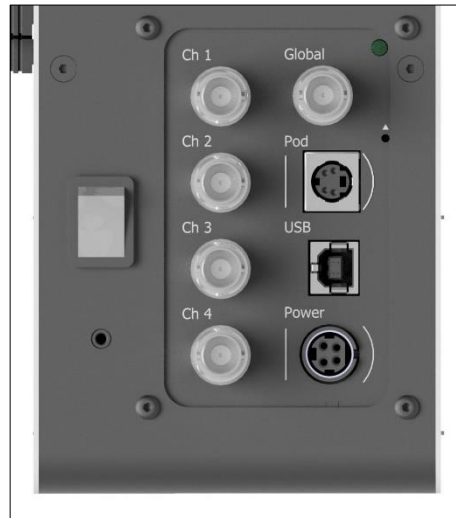
Abbildung 16 - Die Rückseite der Lichtquelle -pE-400 max zeigt den Ein/Aus-Schalter (links) sowie die Pod-Buchse und die Netzbuchsen mit umlaufenden Markierungen zur Orientierung der Anschlüsse (rechts).
