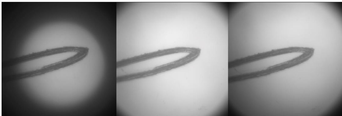
图 51- 从左到右) 样本平面填充不足 (需要调整焦距)、中心亮点 (需要调整焦距)、最均匀 (最佳焦距)。
