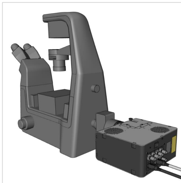
Figura 11- Uma fonte de luz -pE-400 max instalada num microscópio numa orientação horizontal.
