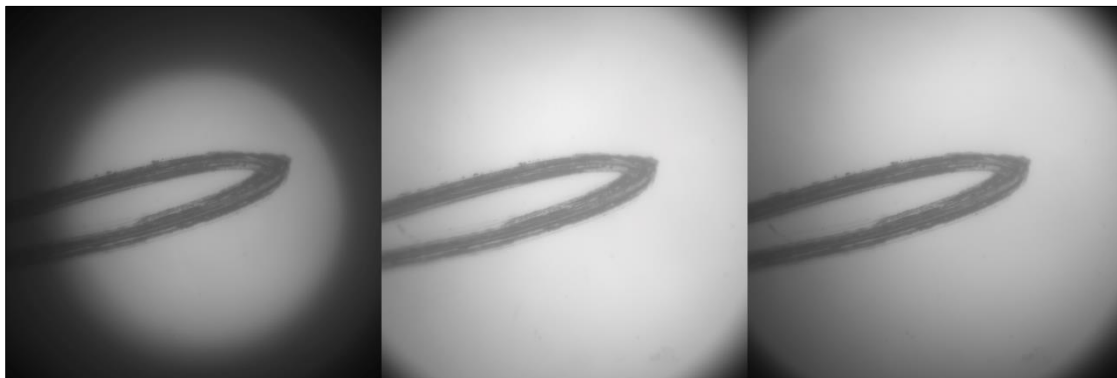
Figura 51 - (Da esquerda para a direita) Um plano de amostra subpreenchido (são necessários ajustes de focagem), um ponto brilhante central (são necessários ajustes de focagem), mais homogêneo (focagem ótima).
