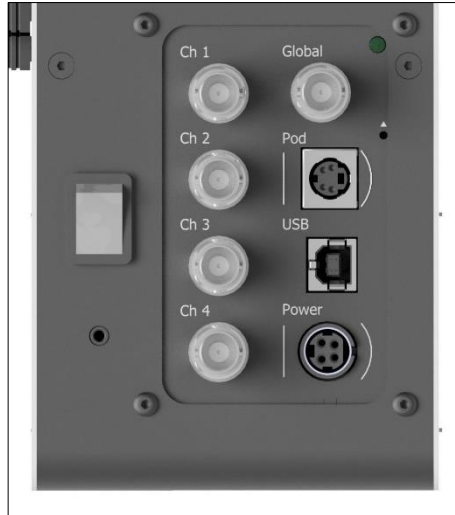
그림 16- - pE-400 max 켜기/끄기 스위치가 표시된 광원 백 패널(왼쪽), 커넥터 방향을 안내하는 주변 표시가 있는 포드 소켓 및 전원 소켓(오른쪽).
