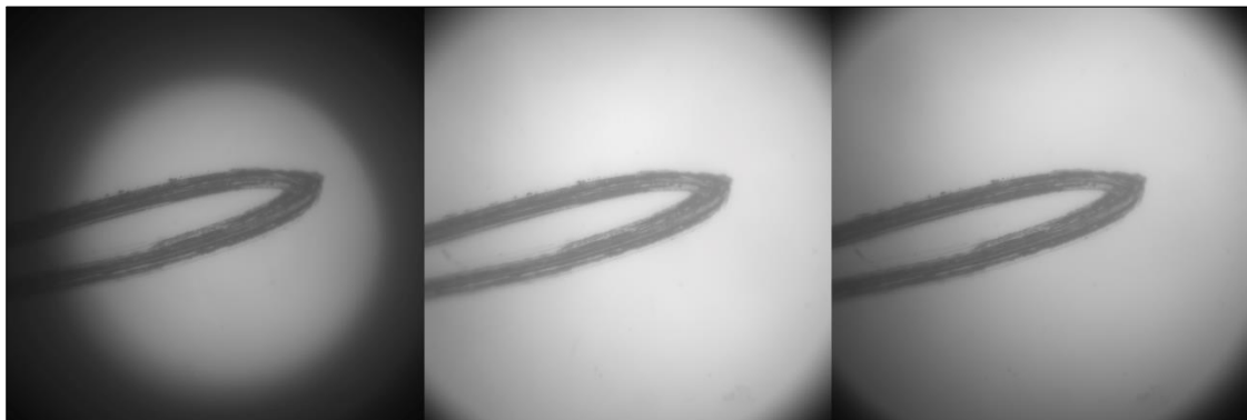
図 51- (左から右へ)試料面が十分に満たされていない(焦点調節が必要)、中央の輝点(焦点調節が必要)、最も均質(最適焦点)。
