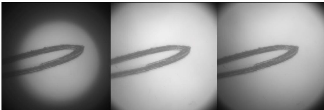
Figure 51 - (De gauche à droite) Un plan d'échantillonnage insuffisamment rempli (ajustements de la mise au point nécessaires), un point lumineux central (ajustements de la mise au point nécessaires), la plus grande homogénéité (mise au point optimale).
