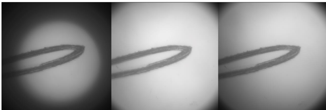
Figura 51 - (De izquierda a derecha) Un plano de muestra poco lleno (requiere ajustes de enfoque), un punto brillante central (requiere ajustes de enfoque), más homogéneo (enfoque óptimo).
